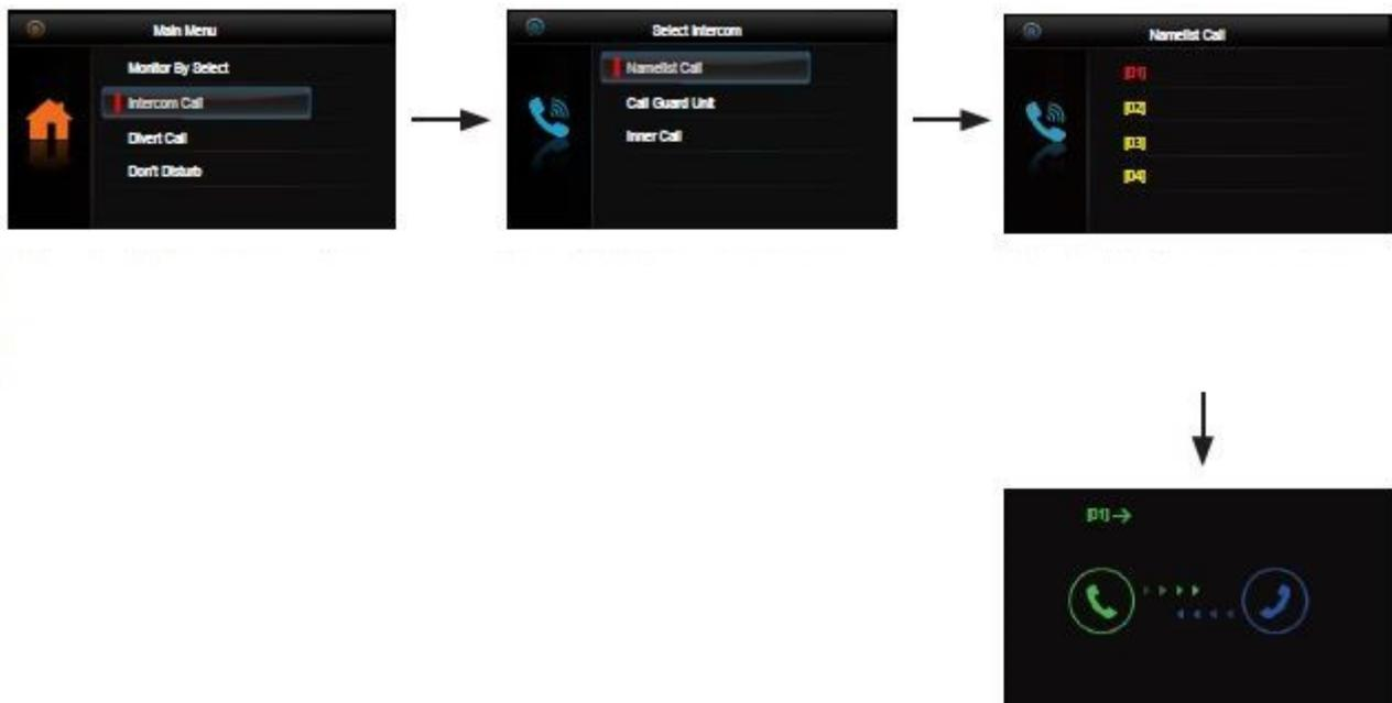
2. **Innerer Anruf:** Wenn sie mehrere Monitore in einer Wohnung installiert haben mit Master/Slaver Einstellung, können sie durch drücken des InnererAnruf-Symbols bei allen installierten Monitoren anklingeln und bei Abnahme kommunizieren.
